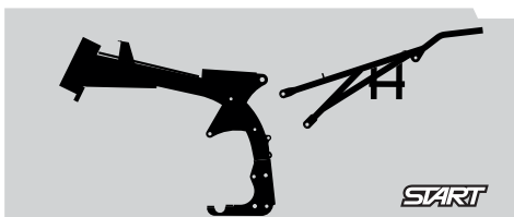
CADRE BLANC RENFORCÉ 88 POUR BRAS MONO (BOUCLE ARRIÈRE INCLUSE) 88 REINFORCED WHITE FRAME FOR MONO SWING ARM (REAR SUBFRAME INCLUDED)
